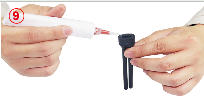
9: Pour RTV silicone inside the main hole of the silicone boot.
